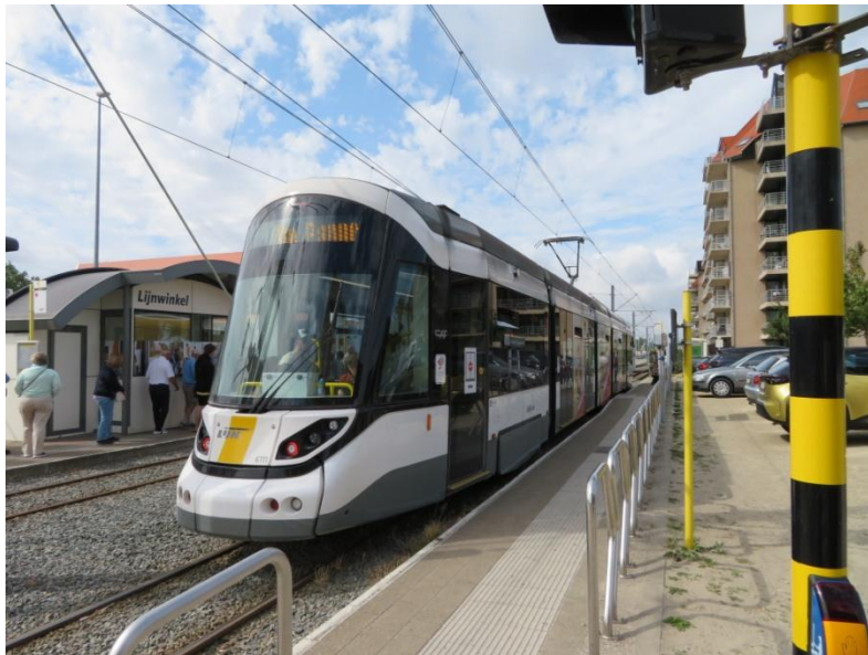
foto 29: De eerste en de laatste tramdeur zijn moeilijk toegankelijk door de grote gaping tussen perron en tram.
